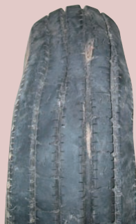
セパレーションを起こし変形している一例
