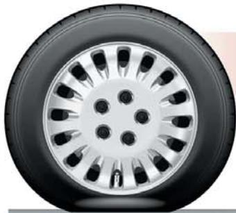
釘穴などにより空気圧が低下したタイヤ
