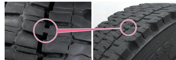
プラットホームが露出した例
