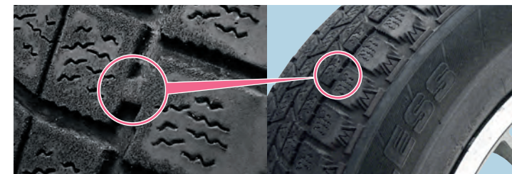
プラットホームが露出した例
